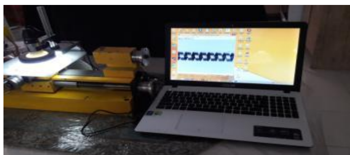
شکل ۲. نمونه اولیه از دستگاه ساخته شده برای اندازه‌گیری گام‌های ماریپچ
